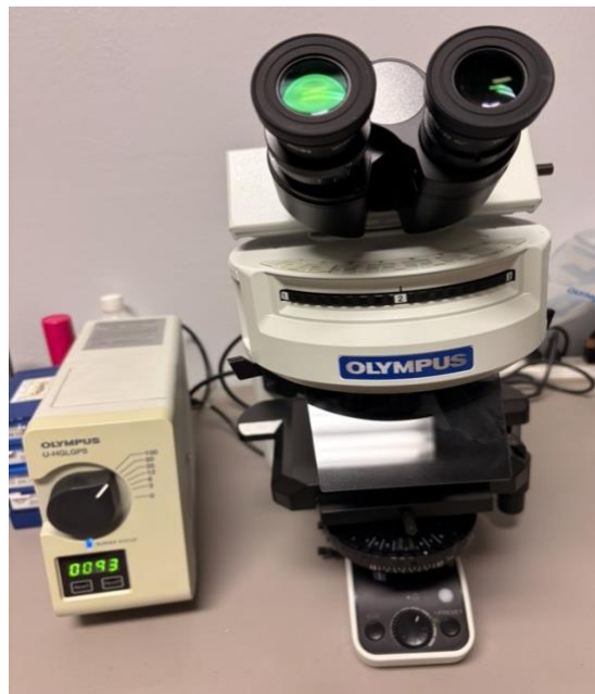
Figura 19 Microscopio de fluorescencia Olympus U-HGLGPS, model: BX53
